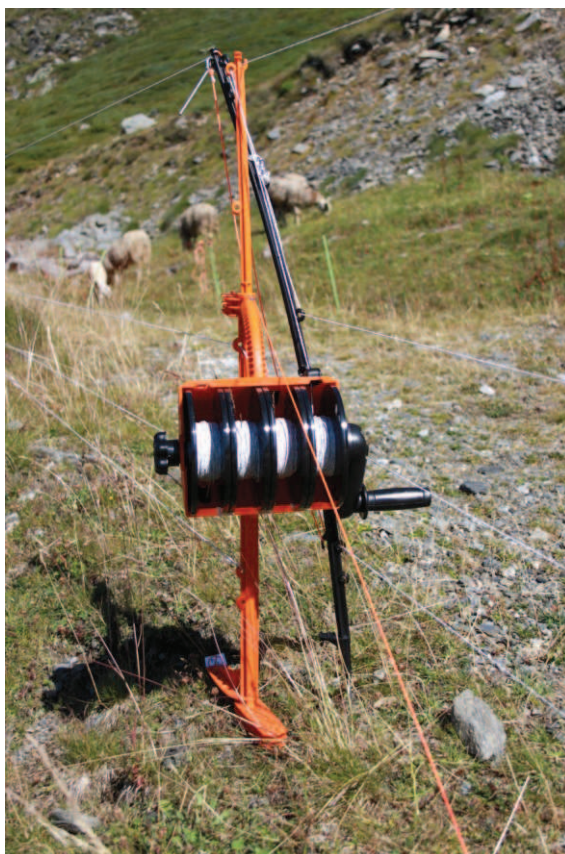
Fig. 4.4 Auto avvolgitore della recinzione esterna
